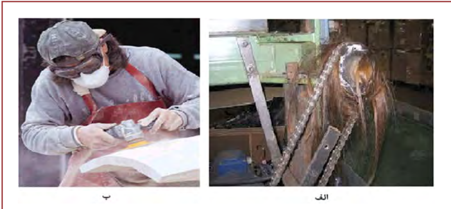
شکل ۴- گیر کردن موهای بلند نامرتب در بین قطعات متحرک و گردنده دستگاه (الف). موهای بلند باید با یک کلاه یا سربند در محیط کار بسته شوند تا مانع حادثه شوند (ب).
