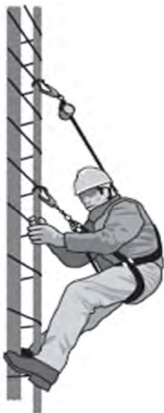
شکل ۴۵- یک سیستم حفظ موقعیت با طناب نجات خود جمع شونده
