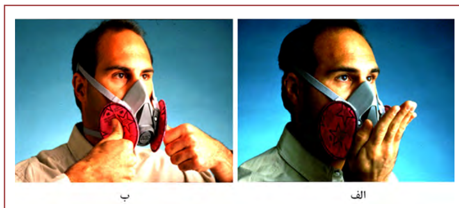
شکل ۳۸ - آزمایش کیپ بودن رِسپیراتور. الف- آزمایش فشار مثبت ب- آزمایش فشار منفی
