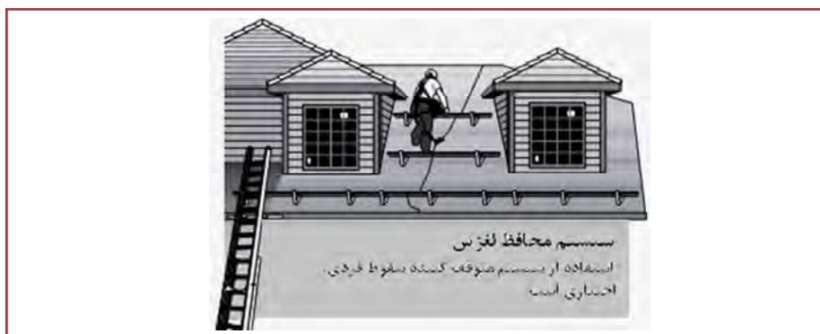
شکل ۴۹- نمائی از یک سیستم محافظ لغزش
